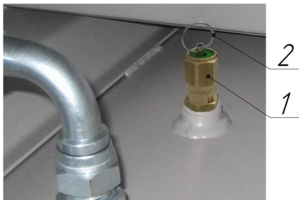
Рисунок 10 – Клапан предохранительный пружинного типа
